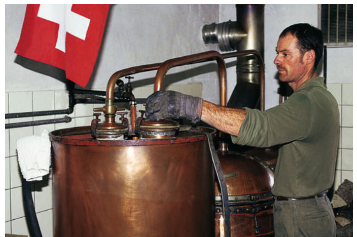
Heizkessel: Hier wird der Wurzelbrei destilliert.
